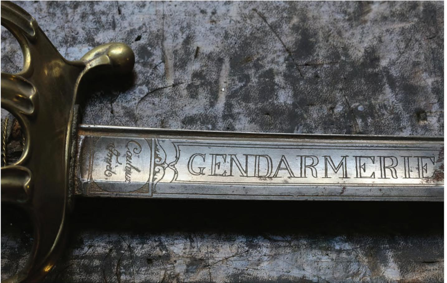
Ci-dessus : détail d'un sabre. La corrosion naturelle ou parfois les chutes de cheval nécessitent des opérations variées telles que soudure, fourbissage et polissage. Page de droite : le maréchal des logis-chef dans son atelier. Outre le travail du métal, les armuriers réalisent les poignées en bois de hêtre, recouvertes de cuir et de laiton torsadé.
